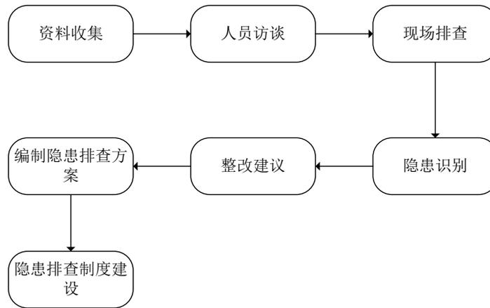
图 1-1 隐患排查工作流程图
