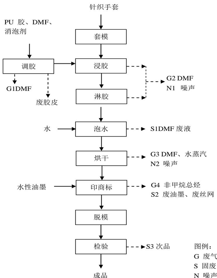
图 2.4-1 生产工艺流程图
