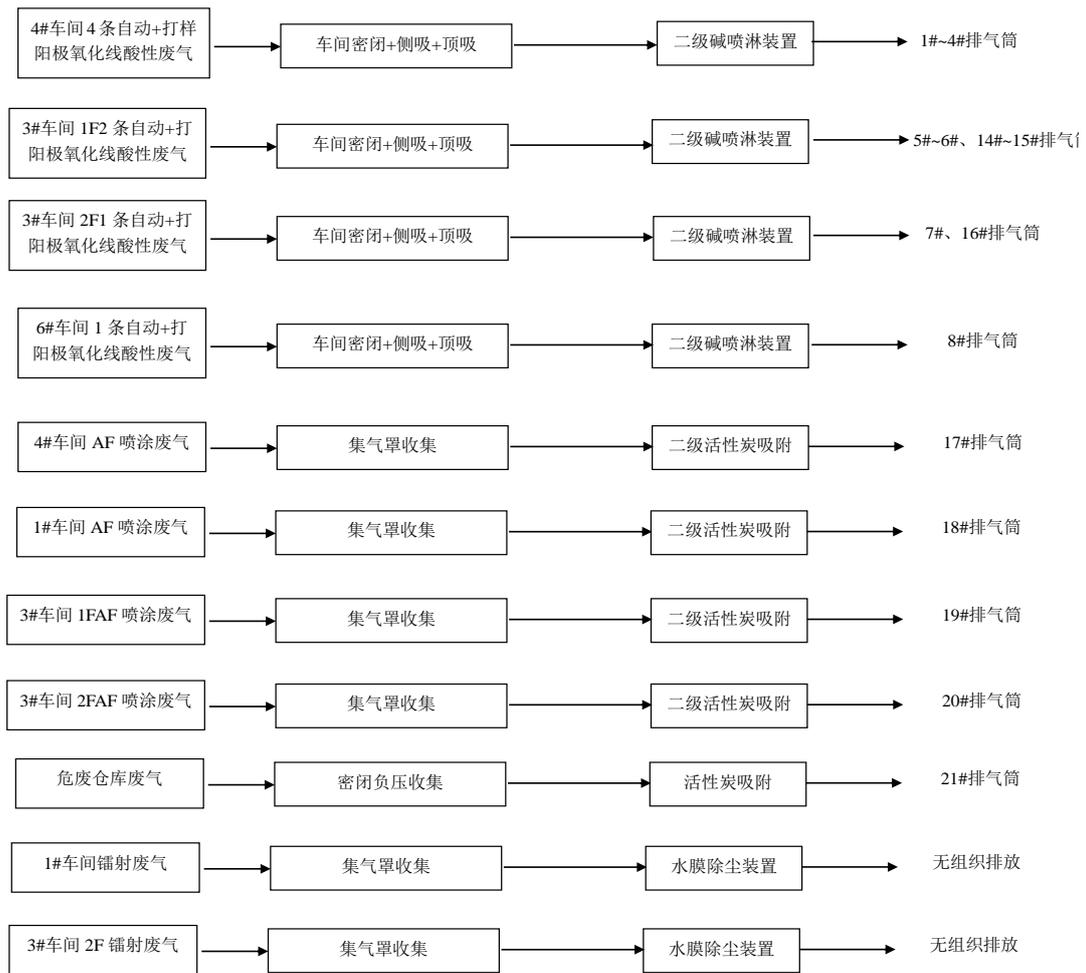
图7.1-1 项目各股废气收集、处理、排放路线图
